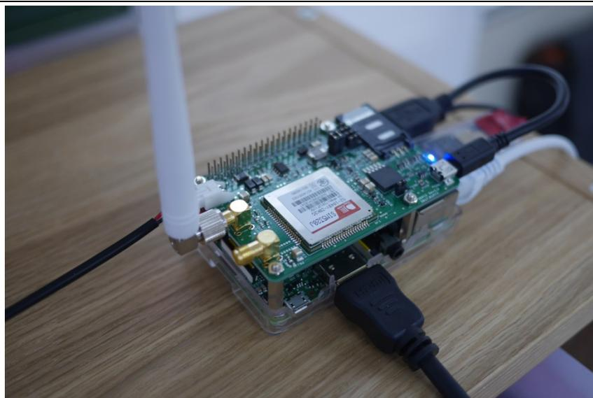
図 2-2 親機：下側がボードコンピュータ、上側が通信ボード
