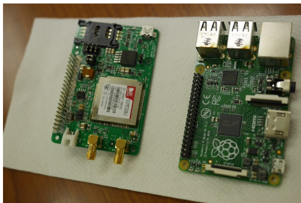
図2 親機 右はコンピュータで左は 3G 通信基盤
