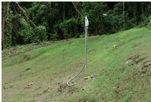
図3 センサー部はアンテナコードとアンテナ本体
