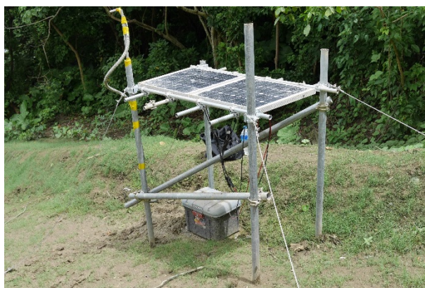
図4 親機部は、ソーラーパネル、バッテリー、コントローラ、ケース等
