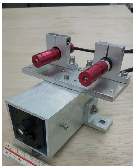
写真 1.3.1-1 点検カメラ 上部の赤い円筒部分はレーザー光源
